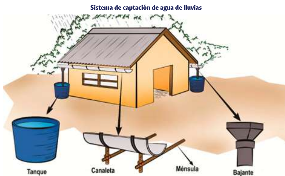
Ilustración 1: Sistema de captación de agua de lluvia ilustrado. Tomado de Tecnologías para cosechar lluvias [ilustración] AGRO-NOTICIAS, 2018, https://agronoticias.pe/ciencia-e-innovacion/tecnologias-para-cosechar-lluvias/
