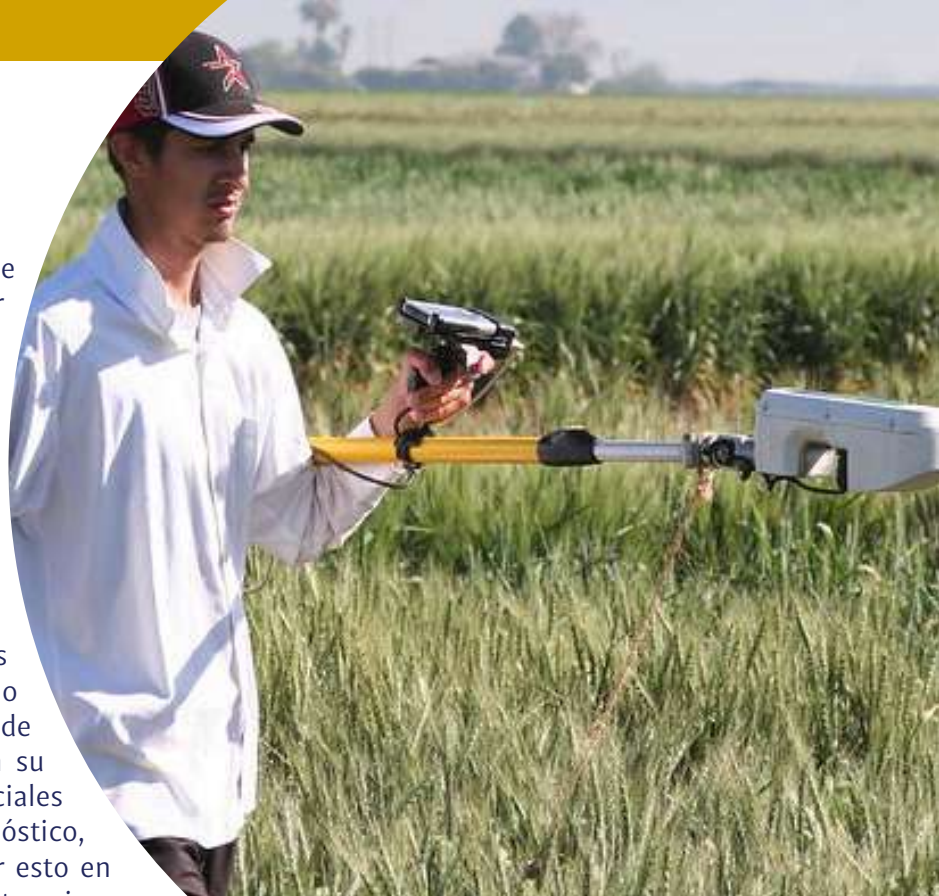
Técnico del CIMMYT utiliza un sensor manual para medir el NDVI (Índice vegetativo diferencial normalizado) en un campo de trigo en la estación experimental CENEB del centro, cerca de Ciudad Obregón, Sonora, en el norte de México.. Fotografía: CIMMYT
