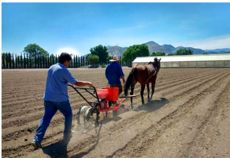
Fotografía: Mecanización para pequeños predios. Siembra y fertilización de maíz con prototipo de sembradora para animales de tiro. (Foto: Gabriel Martínez)
