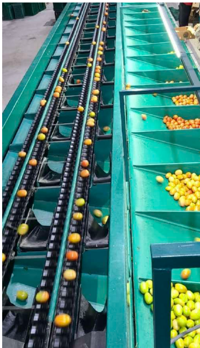
Foto 3: Máquina seleccionadora de jitomate (Imagen de autoría propia).
