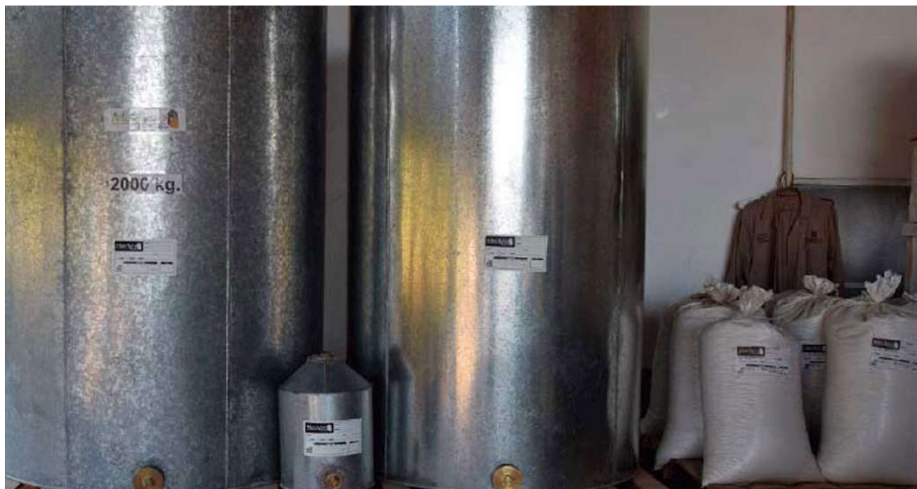
Fotografía: Silos metálicos que minimizan las pérdidas de granos. (Foto: CIMMYT)
