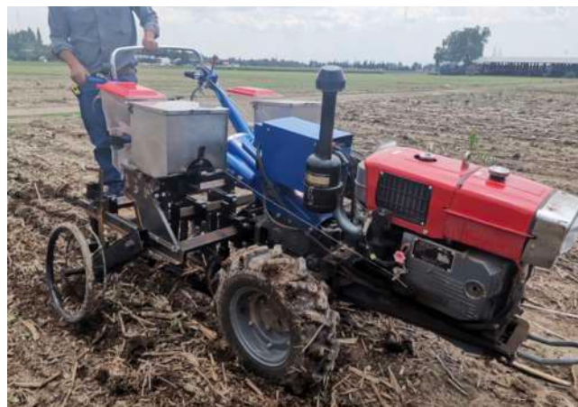
Fotografía: Sembradora fertilizadora acoplada a un tractor de dos ruedas. (Foto: Gabriel Matínez)
