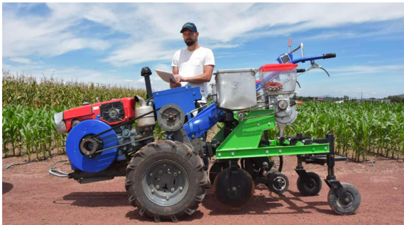
Fotografía: Prototipo de sembradora basada en el concepto multiuso-multicultivo acoplada a un tractor de dos ruedas (Foto: Francisco Alarcón)
