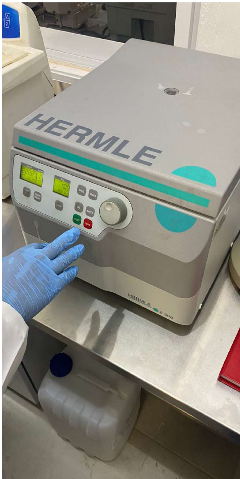
Imagen 7. Imagen del autor. Se centrifugó la muestra a 10,000 RPM durante 5 minutos.
