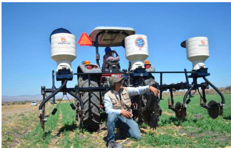
Fotografía: Fertilizadora modular. El uso de componentes independientes brinda una mayor flexibilidad a las máquinas agrícolas, permitiendo adaptarlas a las necesidades específicas de los agricultores. (Foto: Amador Aguillón)
