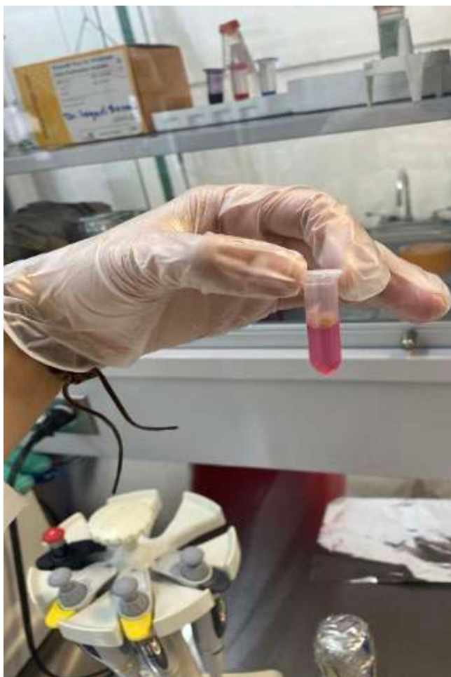
Imagen 5. Imagen del autor. ADN y ARN (parte líquida transparente superior), separa con cloroformo.
